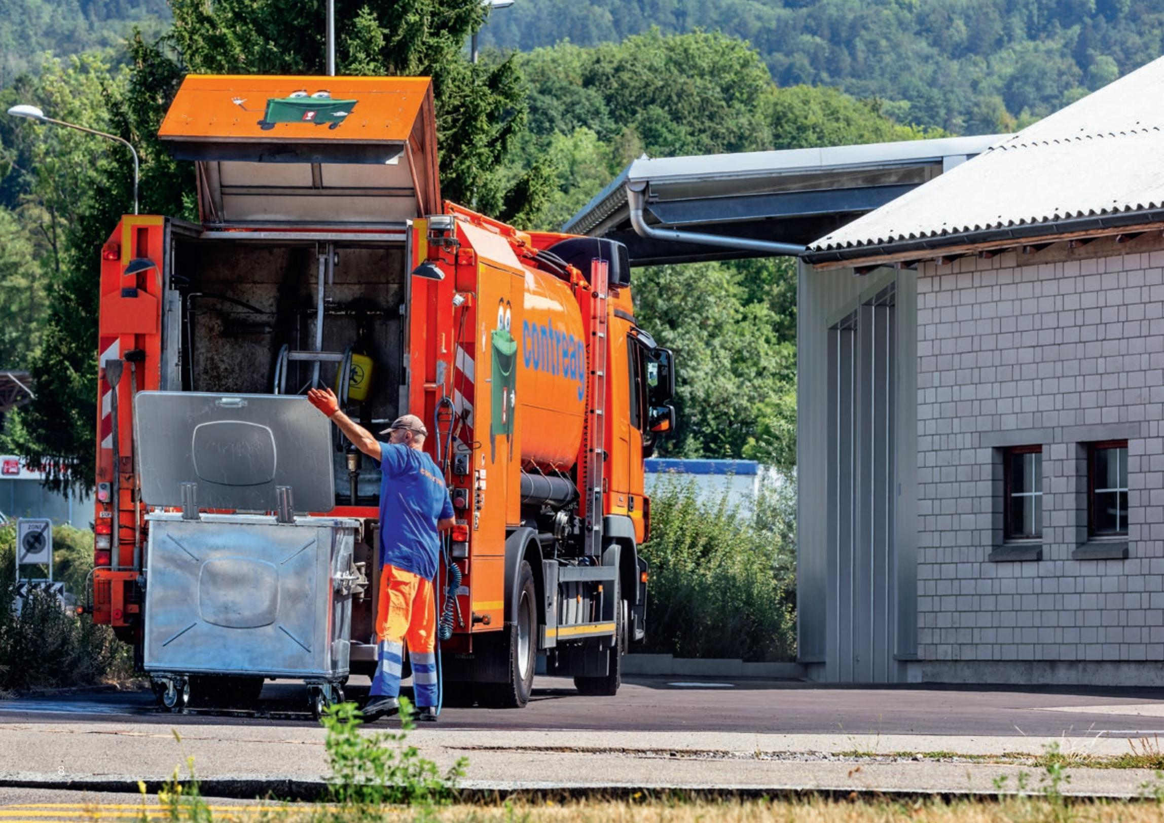
Gereinigt werden Container aller Art und Grösse aus Stahl und Kunststoff in einem umweltfreundlichen Reinigungskreislauf mit Frischwasser und Hochdruck. Direkt vor Ort in einem Spezial-Reinigungsfahrzeug.
