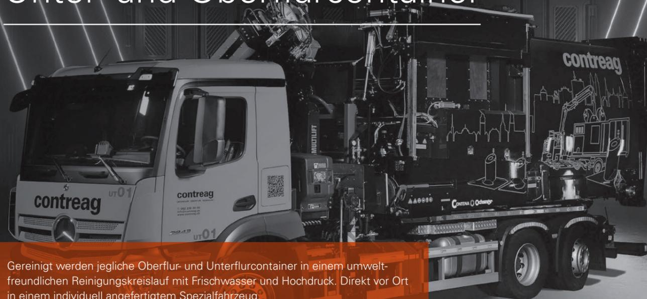
Gereinigt werden jegliche Oberflur- und Unterflurcontainer in einem umweltfreundlichen Reinigungskreislauf mit Frischwasser und Hochdruck. Direkt vor Ort in einem individuell angefertigtem Spezialfahrzeug.
